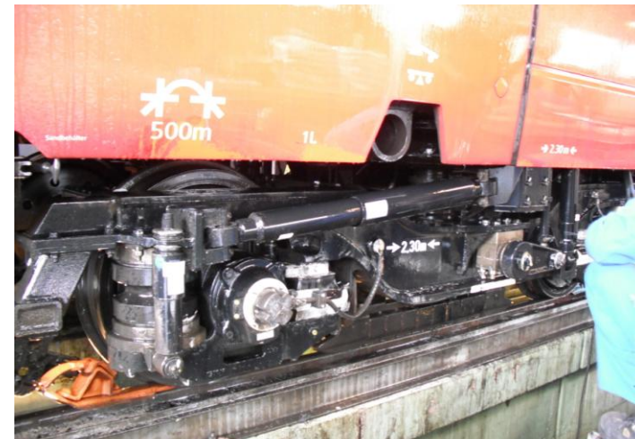
Drehgestell/Radsatz, im montierten Zustand
