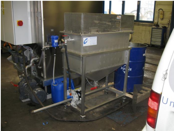
Fettabscheider mit Kratzkettenförderer
