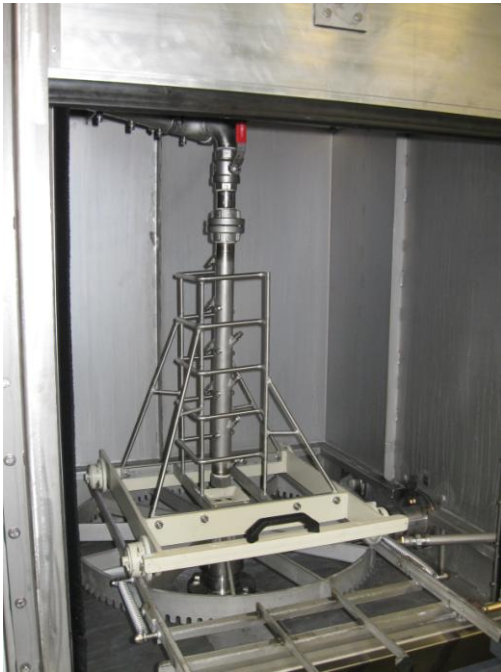
Mittelspritzrohr zur Lagerinnenreinigung
